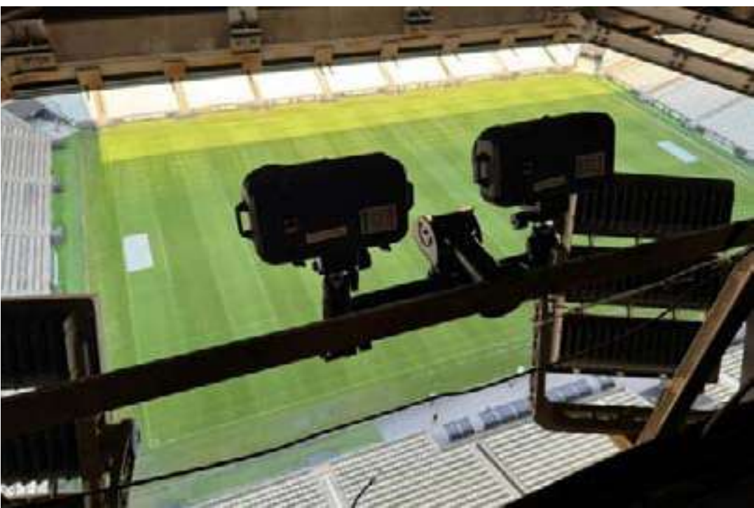
Câmeras para a implementação do impedimento semiautomático, na Neo Química Arena
